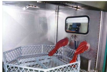
Spritzkabine mit Korb, Düsenrahmen und optionaler Handwascheinrichtung.
