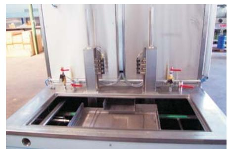
Düsenrahmen mit einstellbaren Düsen.
