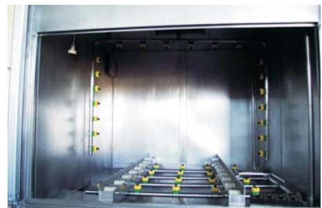
Bsp.: Beschickung der Anlage mit Transportwagen. Damit kann der Waschkorb der Anlage an beliebiger Stelle gefüllt und zur Anlage gefahren werden. Das Beschicken wird nach Arretieren des Wagens möglich.
