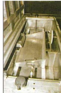
Düsenrahmen mit einstellbaren Düsen. Die Einstellmöglichkeit der Düsen erhöht die Wirksamkeit der Anlage um ca. 30 %. Durch das Schnellwechselsystem ist die Reinigung der Düsen sehr schnell und einfach durchführbar.
